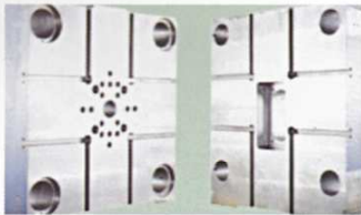
采用有限元分析校核之模板, 应力分布合理, 变形小, 合模精度高。
