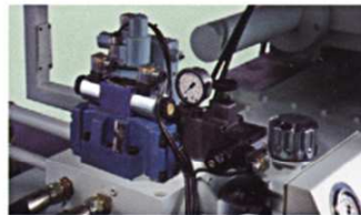
电比例控制系统压力和流量, 具备多级压力和速度控制以及低压合模保护能力。
