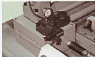
电比例控制系统压力和流量, 具备多级压力和速度控制, 以及低压合模保护功能
